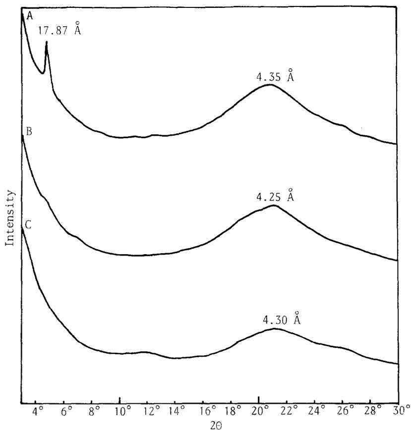
Figure 1 : X-ray diffraction diagrams of : A) IP ; B) IIP ; C) IIIP.
